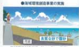
●海域環境創造事業の実施 海域環境創造事業（シーブルー事業）閉鎖性の海域における水環境の改善を図るため、浚渫工事等で発生する良質な土砂を活用して汚泥上への覆砂を行う事業。
