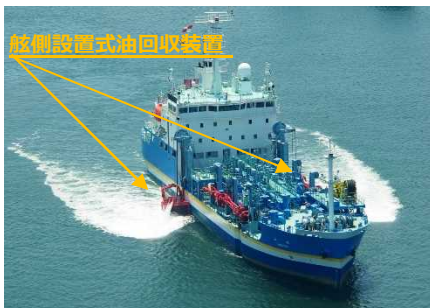
取り込んだ油と水はサイクロン室で遠心分離され、給水ポンプで油だけが船内の回収油水槽へ送られます。
