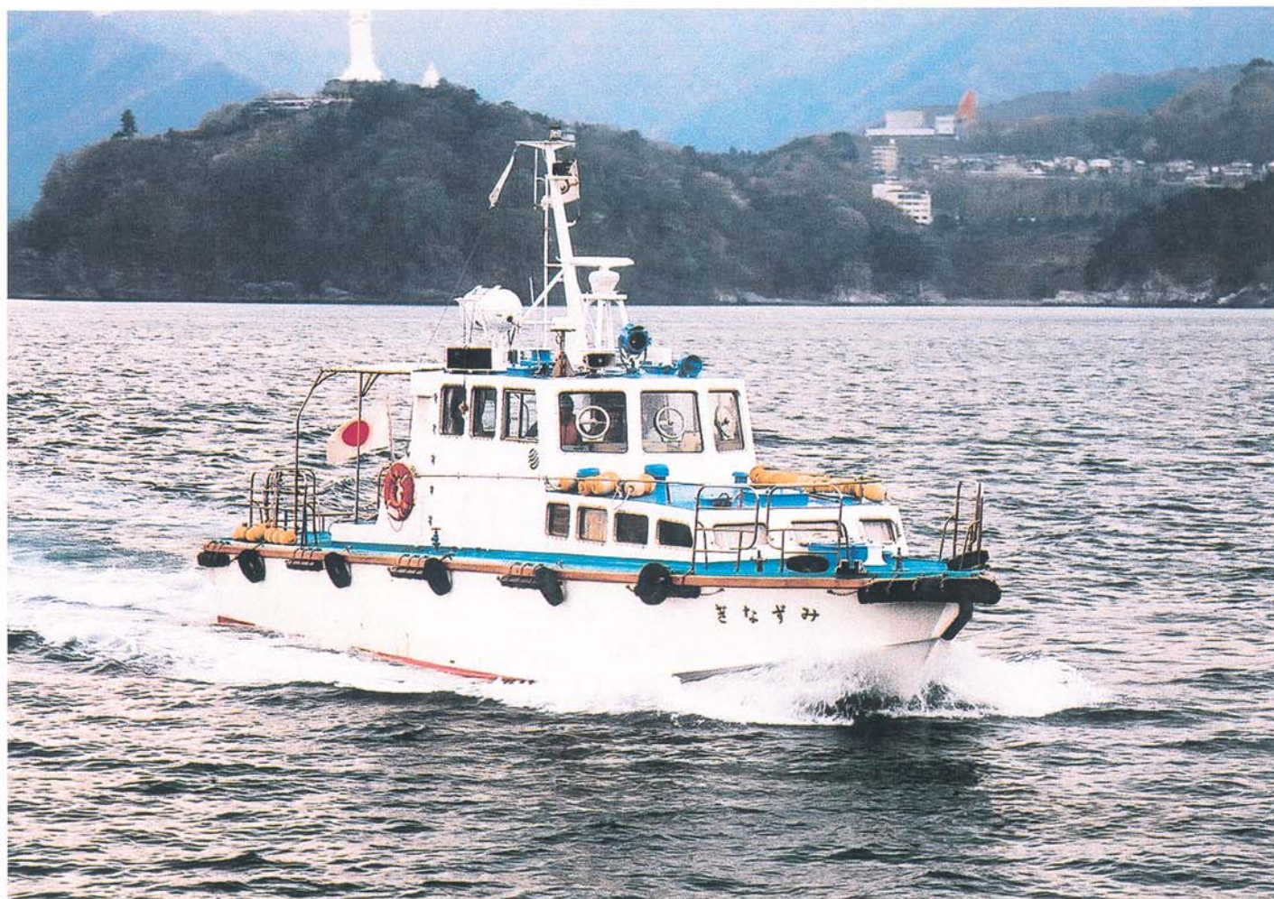
高精度測量システムを搭載した監督測量船「みずなぎ」
