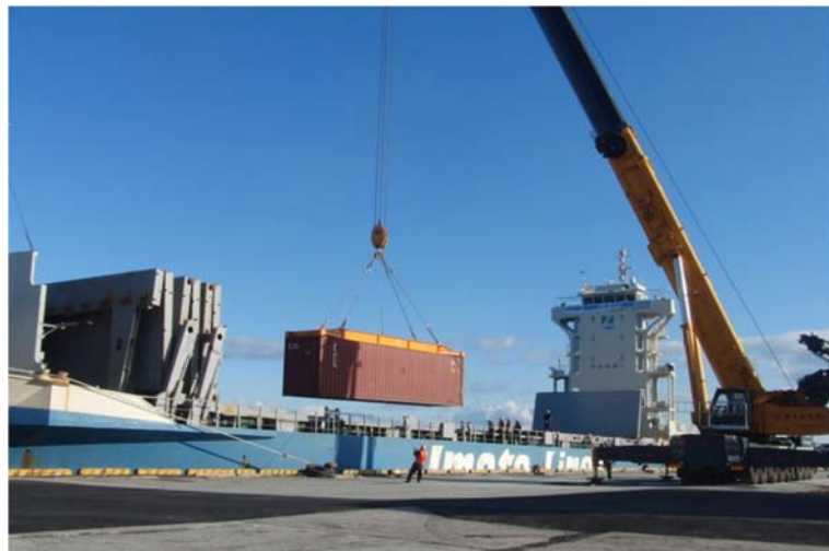
▲代替クレーンによる荷役作業
