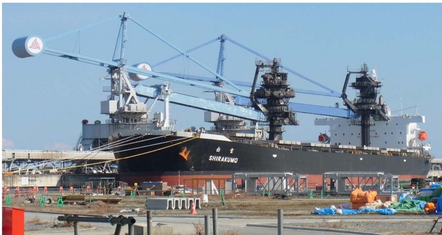
▲揚炭機2基を用いた荷揚げ作業の様子
