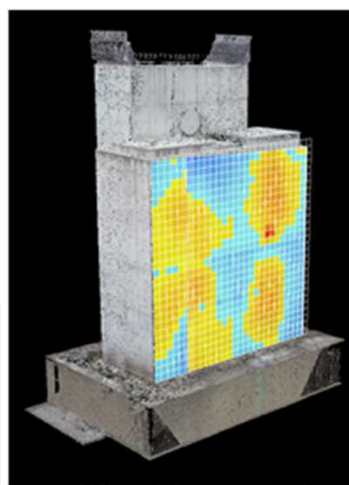
3D設計と点群データの対比による面評価
