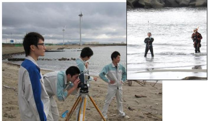
写真 3.1.2 測量の様子 (左: トータルステーション、右: ピンポール)
