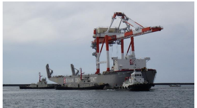
タグボート3隻が連携しながら、ガントリークレーン専用運搬船を移動
