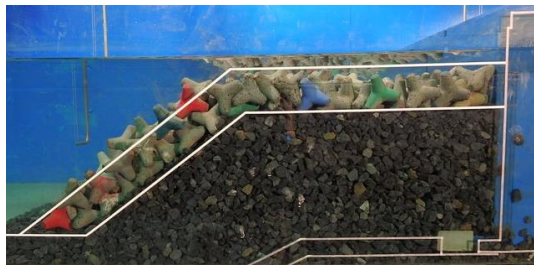
写真-2 波高5.70mによる没水型・消波ブロック8t型の断面変化
