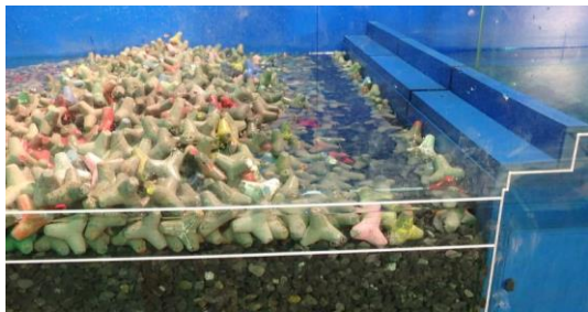
写真-1 波高5.70mによる干出型・消波ブロック8t型のマウンド構造物天端の変状
