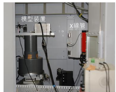
(b) X線CT装置内水平載荷試験 写真-1 X線CT装置および杭水平載荷試験
