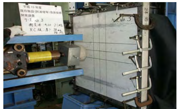
写真一資. 4.1 RC 板取り付け状況
