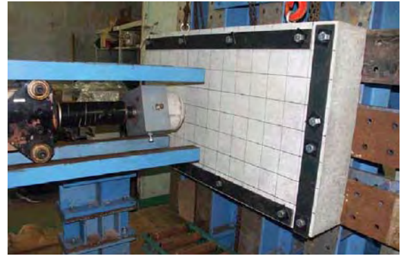
写真一資. 4. 2 RC 板取り付け状況(模型②)
