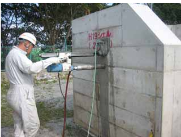
写真 4-15 打継ぎ部からのコア採取状況
