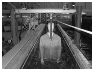
写真-2 流体力の測定
