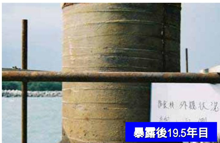
図 ヘトロタム系防食材の外観状況
