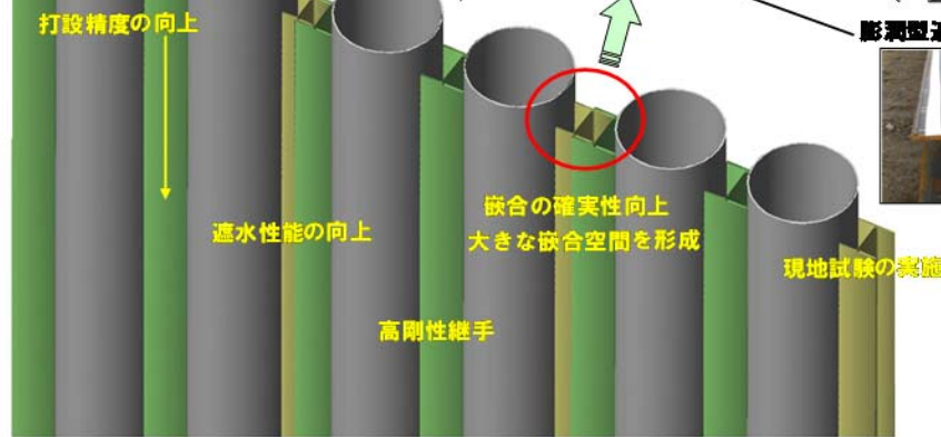
遮水性能に優れた連結鋼管矢板
