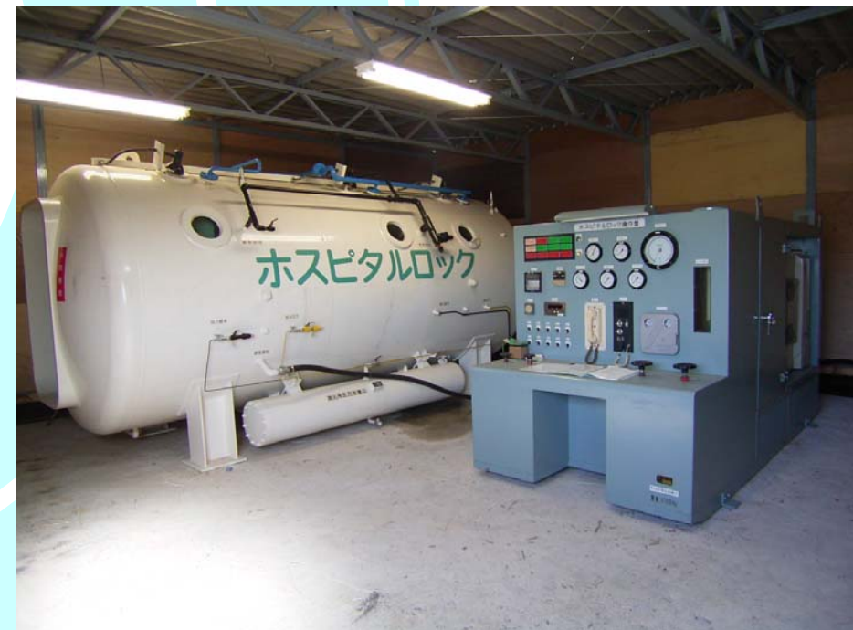
混合ガス用ホスピタルロック
