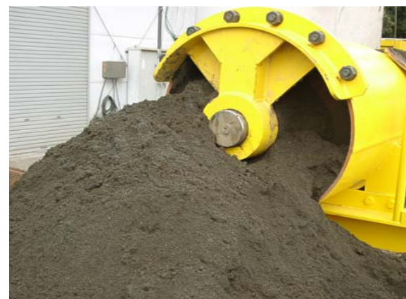
改良後の処理土（第3種処理土）
