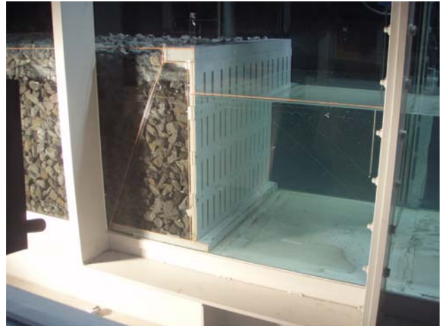
図5 実験状況 (スリット付L型ブロック)
