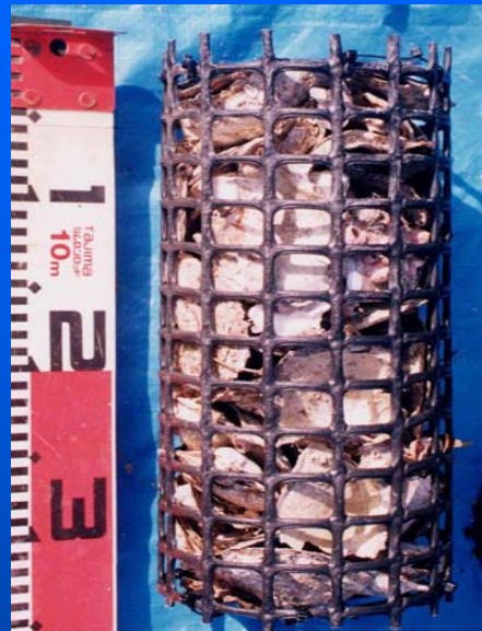
標準テストピース (直径15cm、長さ30cm)
