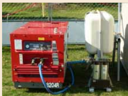
汎用のコンプレッサーを使用して注入が可能です。
