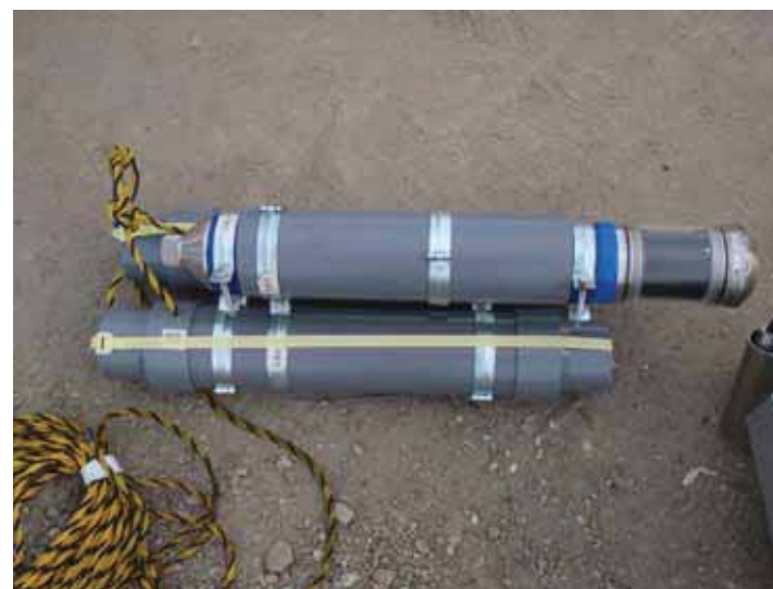
図 2.11-12 鋼管内撮影用水中カメラ
