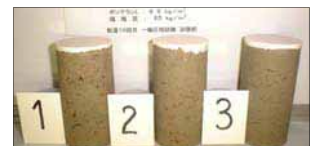
ボンテラン改良土4 (10サイクル終了時 W 0 =150[%] 固化材100[kg/m 2 ])
