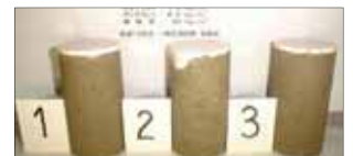
ボンテラン改良土2 (10サイクル終了時 W 0 =105[%] 固化材90[kg/m 2 ])
