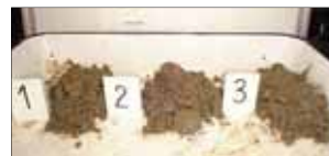
固化处理土1 (2サイクル終了時 W 0 =105[%] 固化材80[kg/m 2 ])
