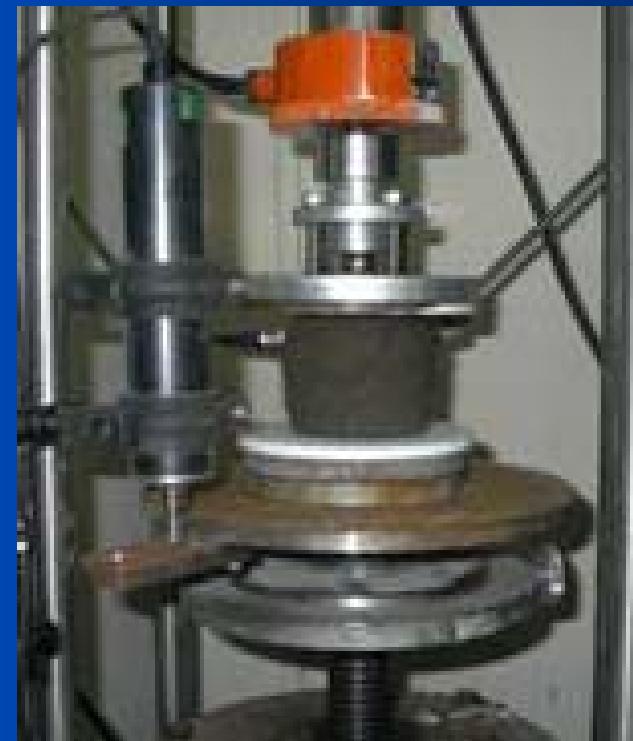
一軸圧縮試験状況
