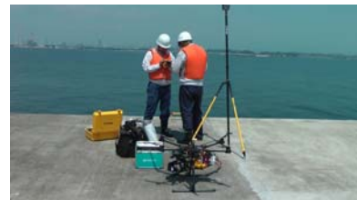
対空標識、検証点観測
