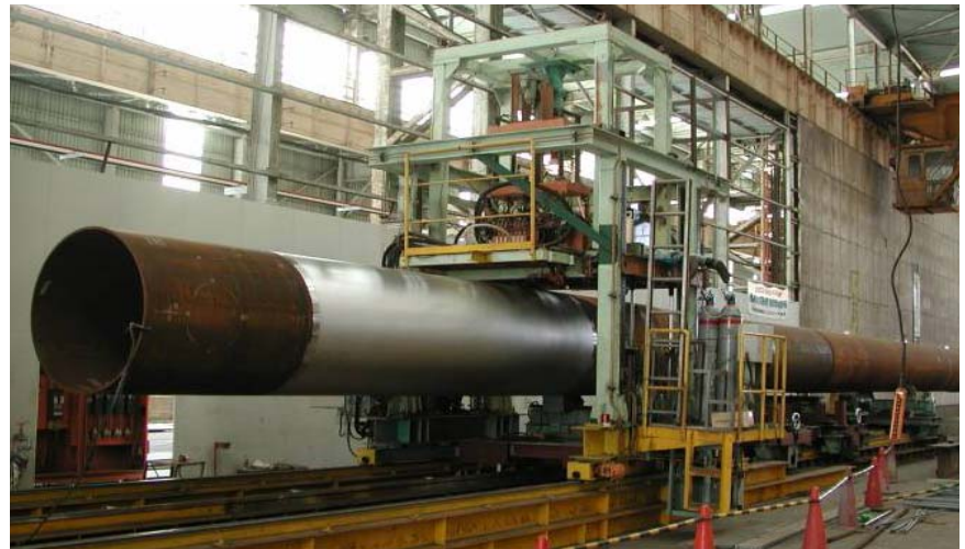
ステンレス被覆設備
