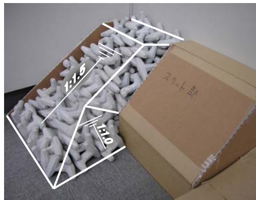
模型を用いた消波ブロック 設置範囲の検討
