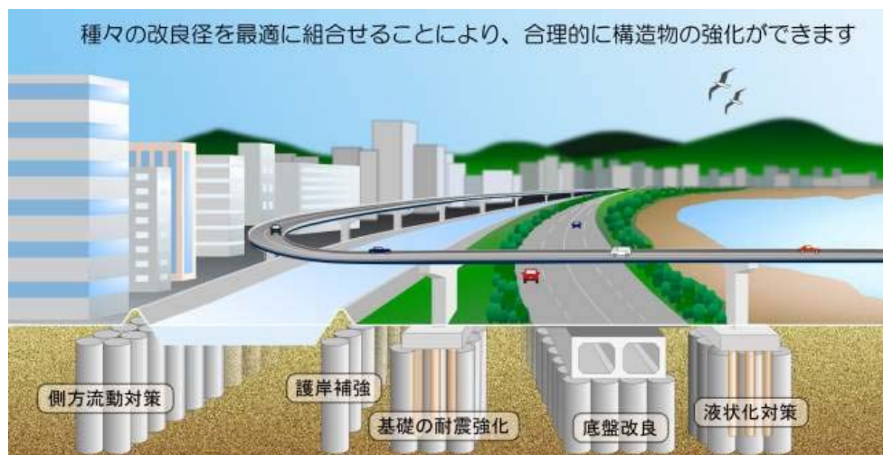
図-3 OPT ジェット工法の適用概念
