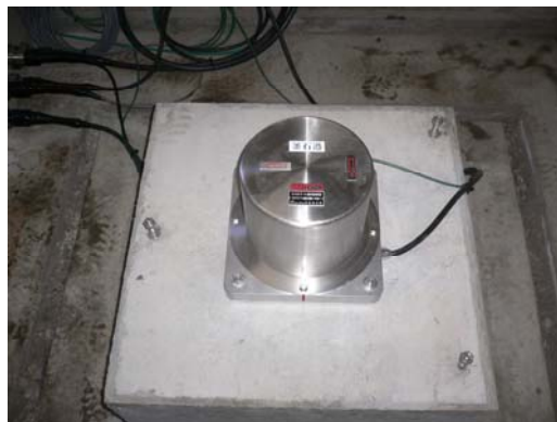
強震計観測機器（地上部）
