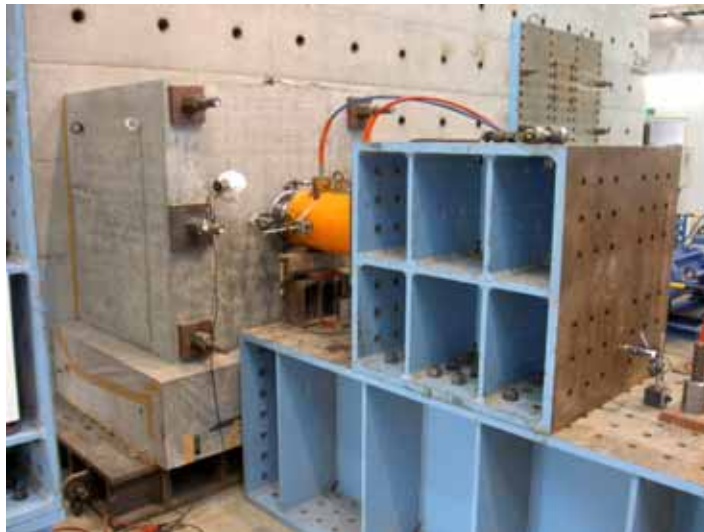
静的載荷実験の状況
