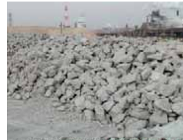
人工石材 (羽田再拡張Proj)
