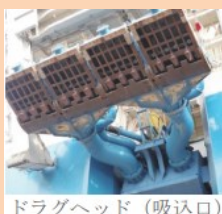
ドラグヘッド(吸込口)で土砂を吸込む ※ドラグは「引きずる」の意
