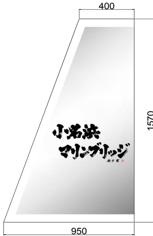
※ステンレス製のプレートを加工し、着色するイメージ
