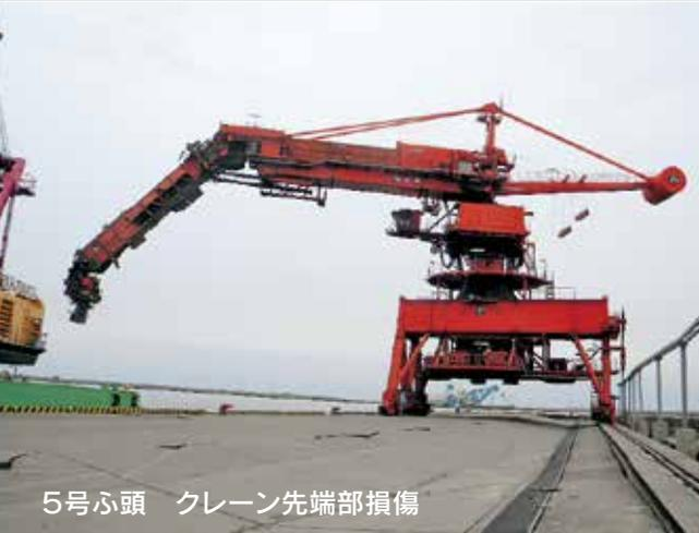
5号ふ頭 クレーン先端部損傷
