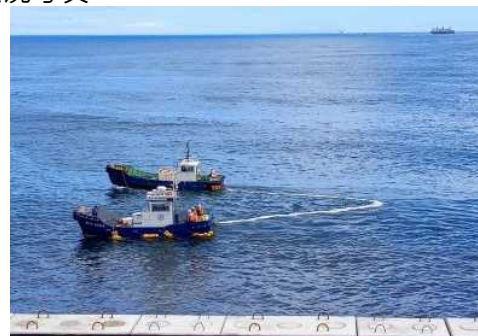
▲埋浚作業船 油吸着材吹き流し型による防除作業状況
