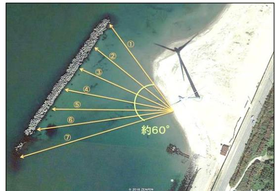
図 3.1 海岸測量の測線配置
