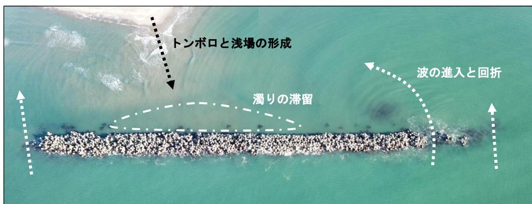
写真 3.2 離岸堤の空撮画像 (下が沖側)
