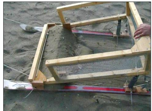
写真 3.4 開発中の漂着マイクロプラスチック回収装置
