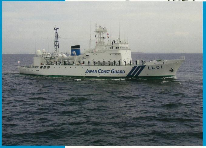
航路標識には、灯台に代表される光波標識、霧笛などの音波標識及び電波を利用した電波標識があります。本船は、ロランC、ディフャレンシャルGPS、AIS(船舶自動識別システム)などの機能の確認及びシステムの改善を図るため、有効範囲、誤差分布状況、電界強度、電波伝搬補正値等など電波標識の解析評価のほか、灯台の光度測定やふくそう海域における通航船舶実態調査を実施しています。また、航路標識業務に対する理解を深めるため、測定航海等の寄港地において
