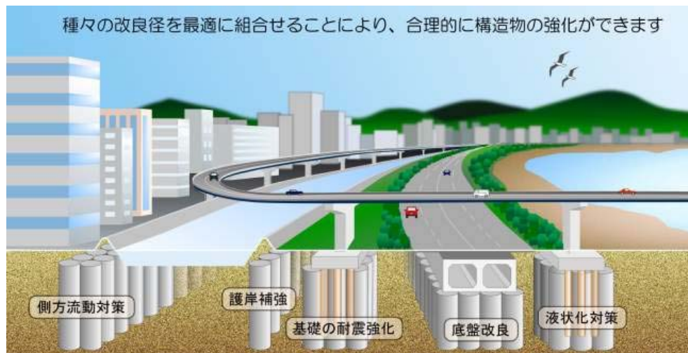
図-3 OPT ジェット工法の適用概念
