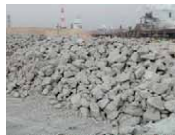
人工石材 (羽田再拡張Proj)
