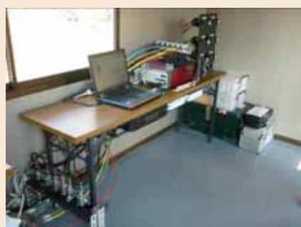
圧力計、流量計にて空気を計測し、減圧弁にて所定条件に制御します。
