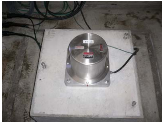
強震計観測機器（地上部）
