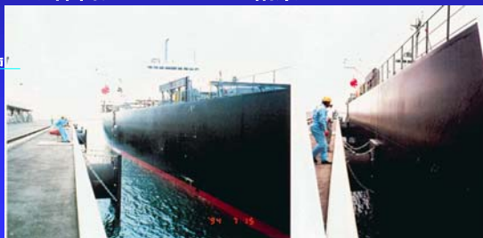
写真1 接岸状況(空気式防舷材へ変更後)
