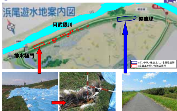
震災後、現地発生土を用いた築堤箇所 (大規模せん断破壊が発生) 平成23年4月撮影
