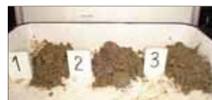
固化処理土1 (2サイクル終了時 W_0=105 [%] 固化材90[kg/m 2 ])
