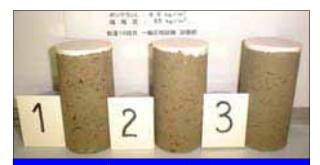
ボンテラン改良土4 (10サイクル終了時 W_0=150 [%] 固化材100[kg/m 2 ])
