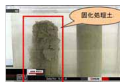
固化処理土の水浸状況
