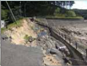
円弧滑り(現地発生土にて築堤)
