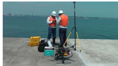
対空標識、検証点観測
