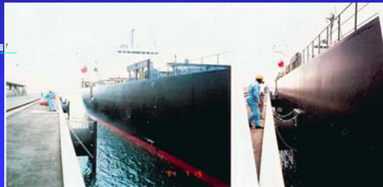
写真1 接岸状況(空気式防舷材へ変更後)
